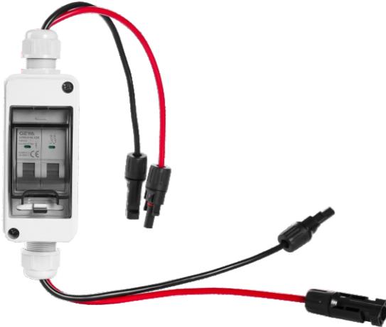
GYHT2光伏连接箱主要用于太阳能电池板与逆变器之间的电路隔离、短路和过载保护，适用于额定电压至600V、额定电流至63A的住宅和商业光伏发电系统。
